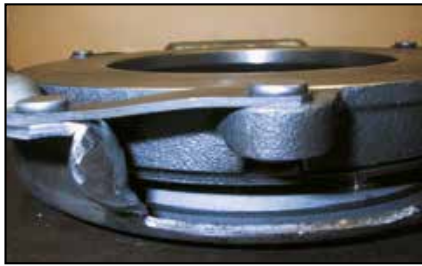
Elemento integro Undeformed drive straps Elemento elástico no deformado Patilha não deformada Недеформированные ведущие накладки
